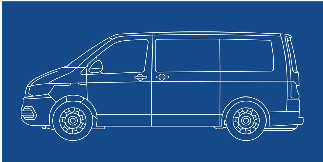
Der Transporter von Volkswagen hat einen 110 bis 150 kW Dieselmotor mit „4Motion“ Allradantrieb und optionaler Differentialsperre hinten. Es stehen eine 6-Gang-Handschaltung oder ein automatisiertes 7-Gang-Getriebe zur Verfügung. Wir bieten sowohl für den kurzen als auch für den langen Radstand einen passenden Ausbau zum Terracamper an.
